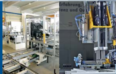
Montagestation mit 6-fach-Schrauber von Alfing Montagetechnik.
